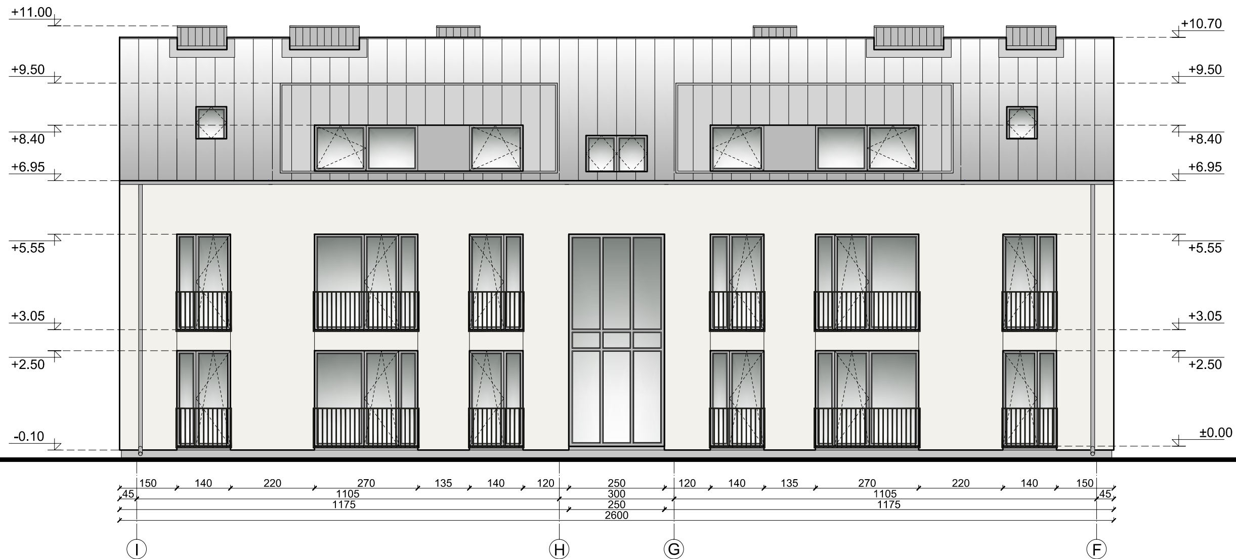
FASADAS TARP AŠIŲ 3-1 M 1:100
