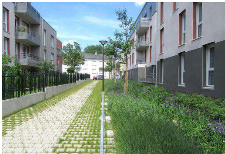
21-22 pav. Mišrios pėsčiųjų tako dangos analogas: dalis tako įrengiama naudojant betonines trinkeles, dalis tako pakraščių įrengiami naudojant drenuojančio tipo ažūrines trinkeles, tarpus užsėjant žole
