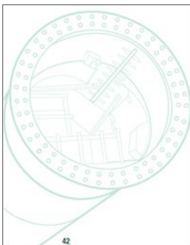
3.2.7.3 pav. Apatinė stiebo sekcija, tvirtinama į pamatą
