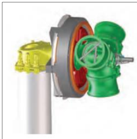
3.2.7.6 pav. Vienos pavaros rotoriaus su generatoriumi pavyzdys
