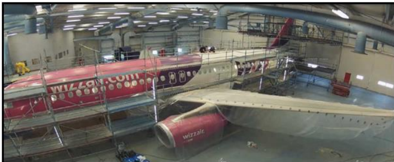
3 pav. Lėktuvo nedažomų dalių uždengimas
