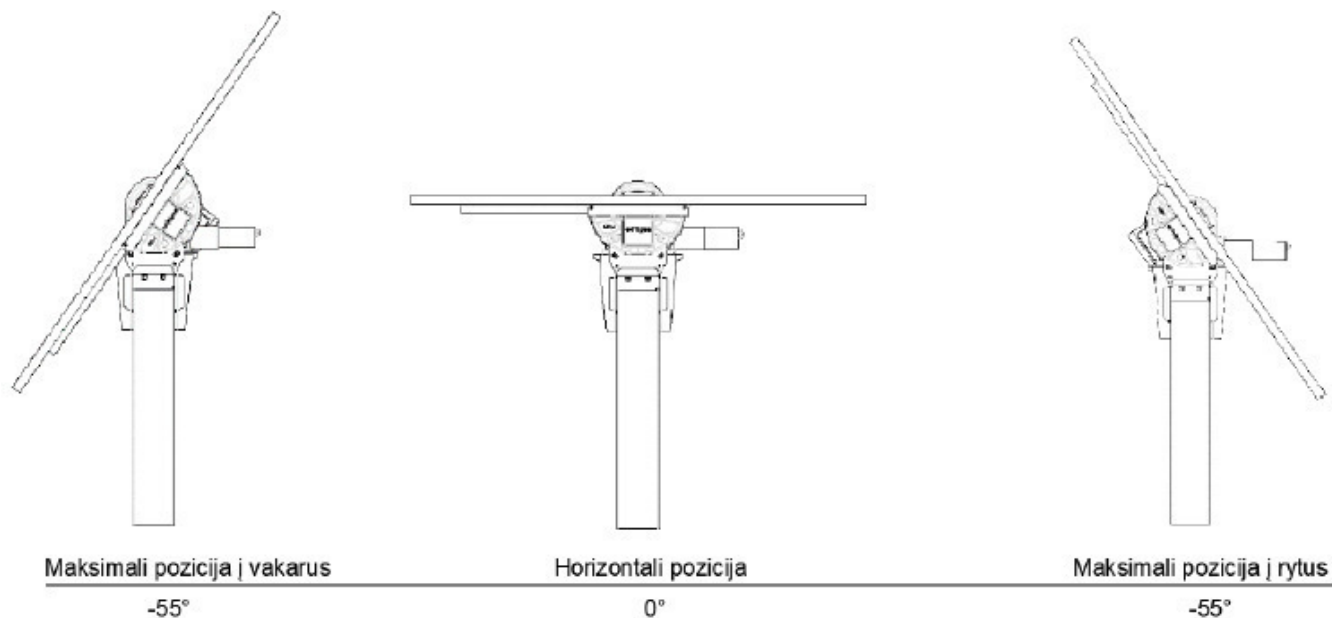
Pav. 1. Konstrukcijų pasisukimo kampas
