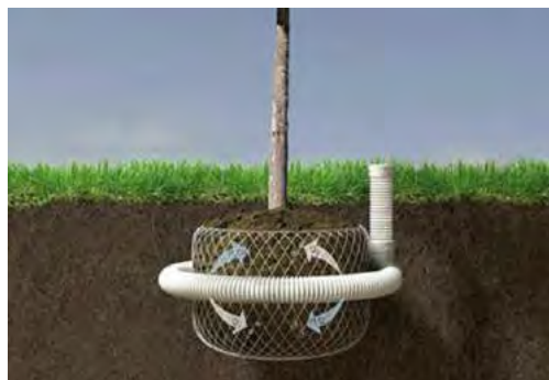
Pav.2 Principinė aeravimo sistemos schema
