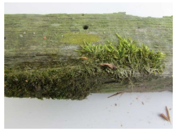
4 pav. Atvežtos medinės konstrukcijos Nr. 2 pažeistos augalų ir entomologinių kenkėjų
