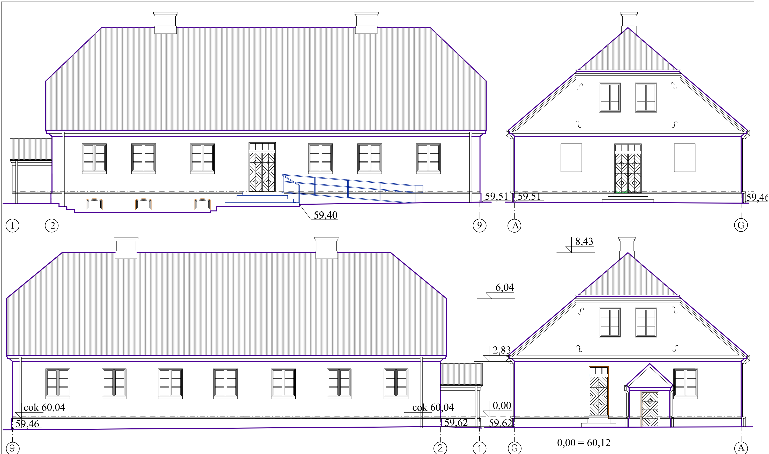
PASTATO FASADAI, STOGAS, LAUKO DURYS, LANGAI RESTAURUOTI I DARBŲ ETAPE.
