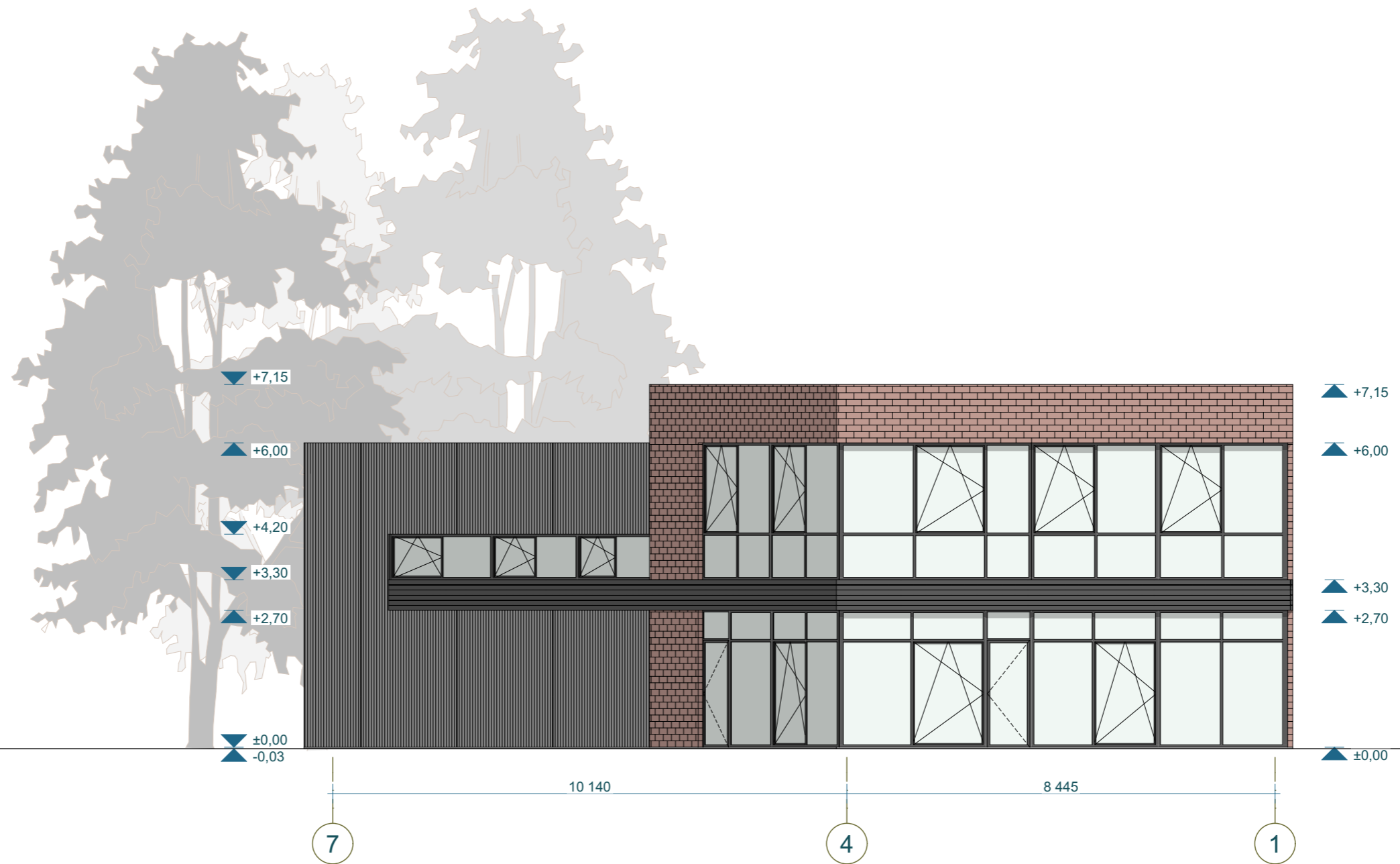
FASADAS TARP AŠIŲ 7-4-1, M 1:100
