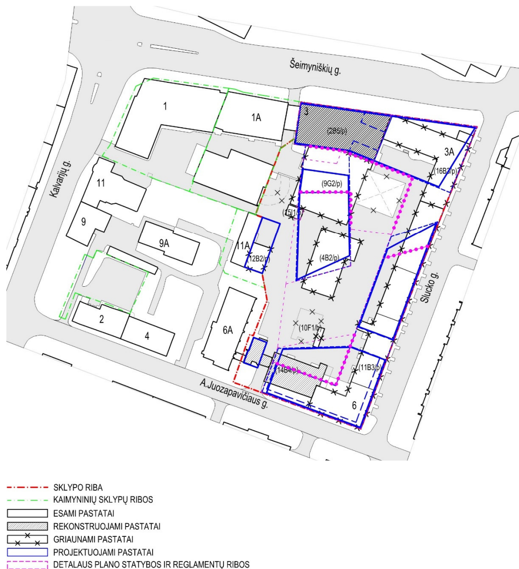
Pav. Nr. 3. Pastatų rekonstravimo schema
