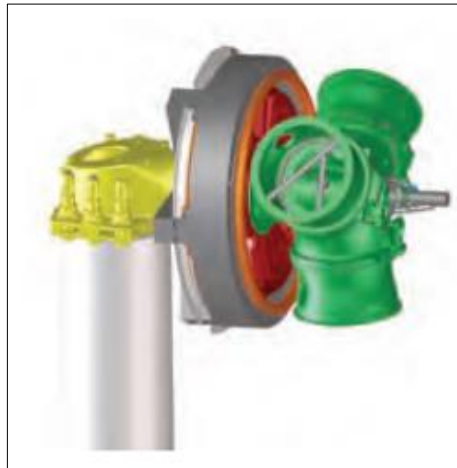
5.6 pav. Vienos pavaros rotorius su generatoriumi
