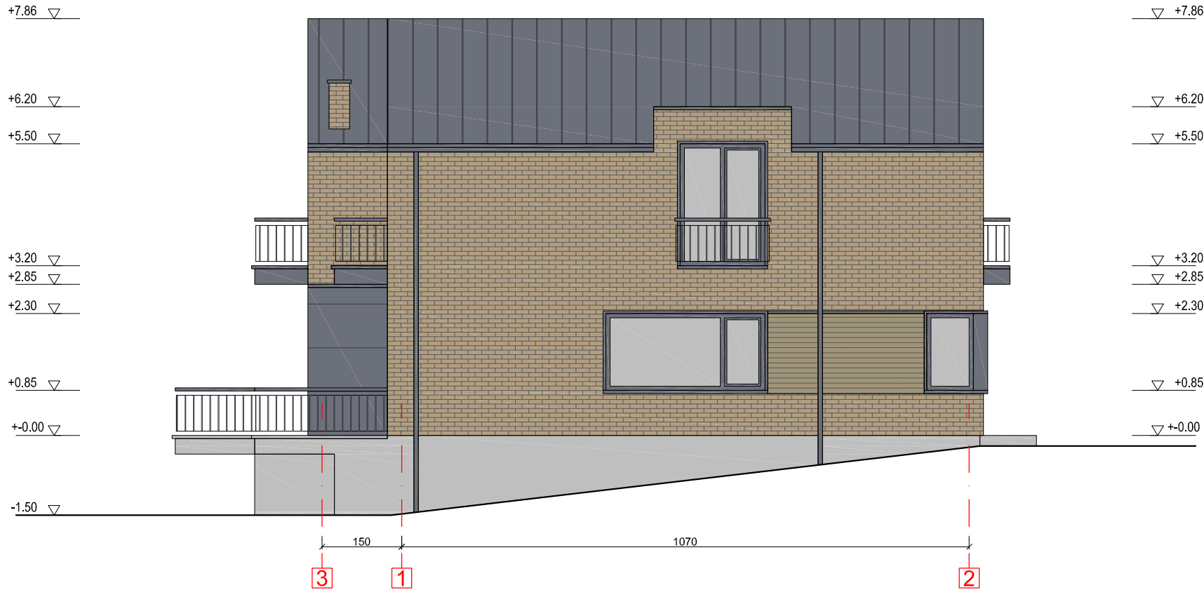
FASADAS TARP AŠIŲ 4-1 M 1:100
