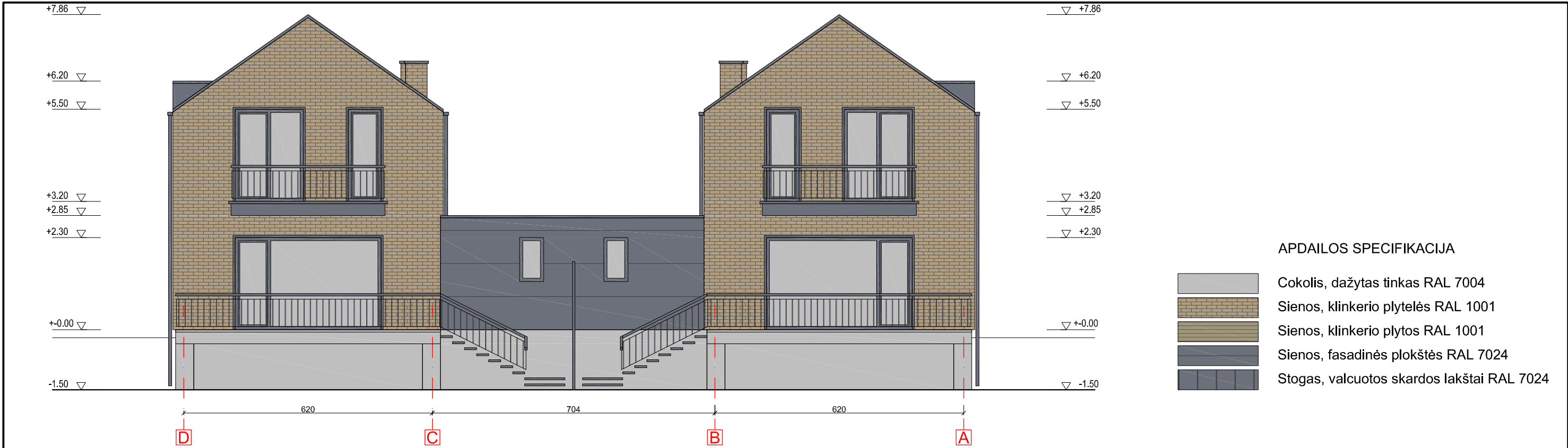
FASADAS TARP AŠIŲ D-A M 1:100
