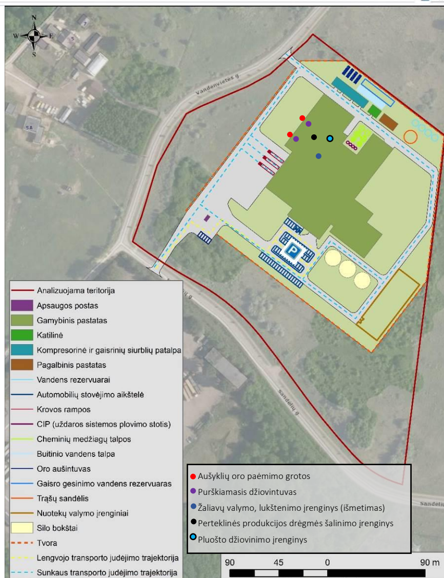
4 pav. Planuojamos teritorijos schema, PŪV sklypo dalies riba, pastatų bei triukšmo šaltinių padėtis bei transporto priemonių judėjimo tipinės trajektorijos
