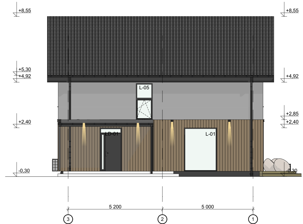
FASADAS TARP AŠIŲ 3-1 M 1:100
