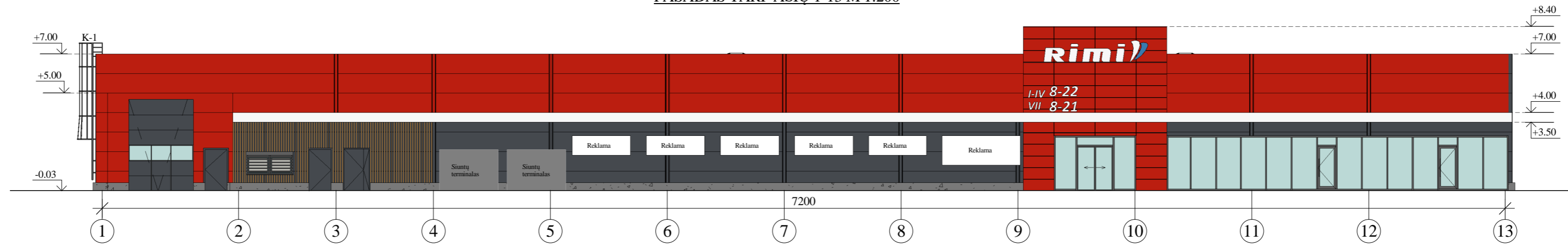
FASADAS TARP AŠIŲ 1-13 M 1:200
