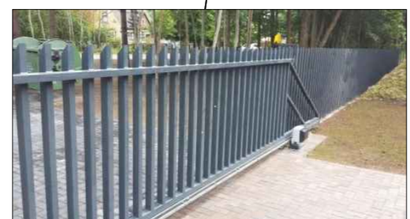
Projektuojama tvora Nr. 2: Fasadinė tvora, vartai ir varteliai - metalinių vertikalių "šukų", spalva RAL 7021; aukštis - iki 1.5m.; ažūriškumas - 75proc. saulės šviesos pralaidumas;
