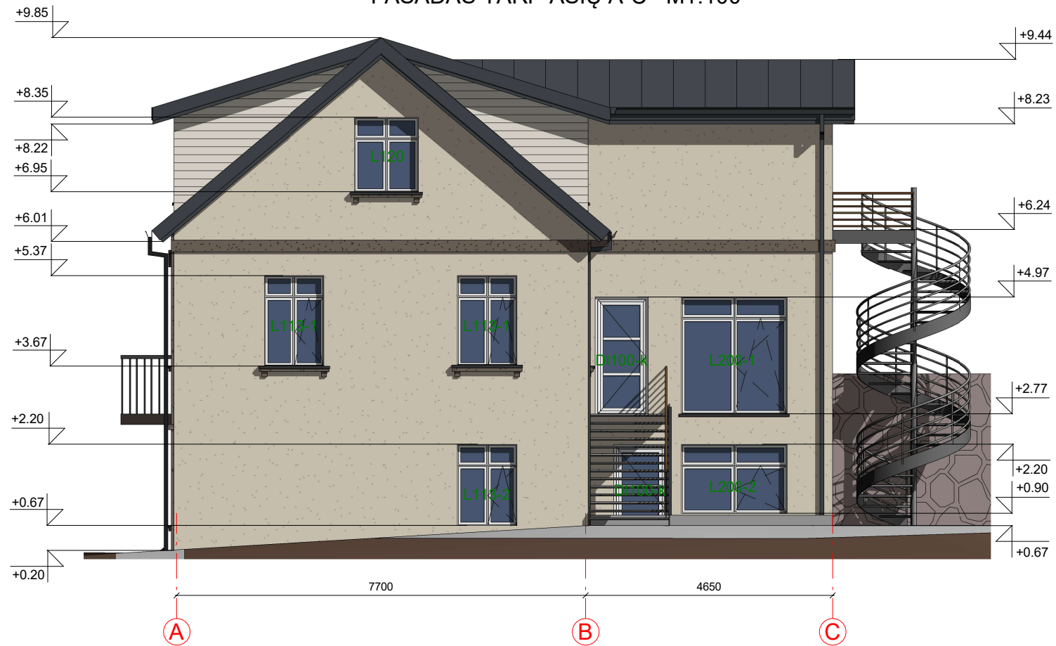
FASADAS TARP AŠIŲ A-C M1:100
