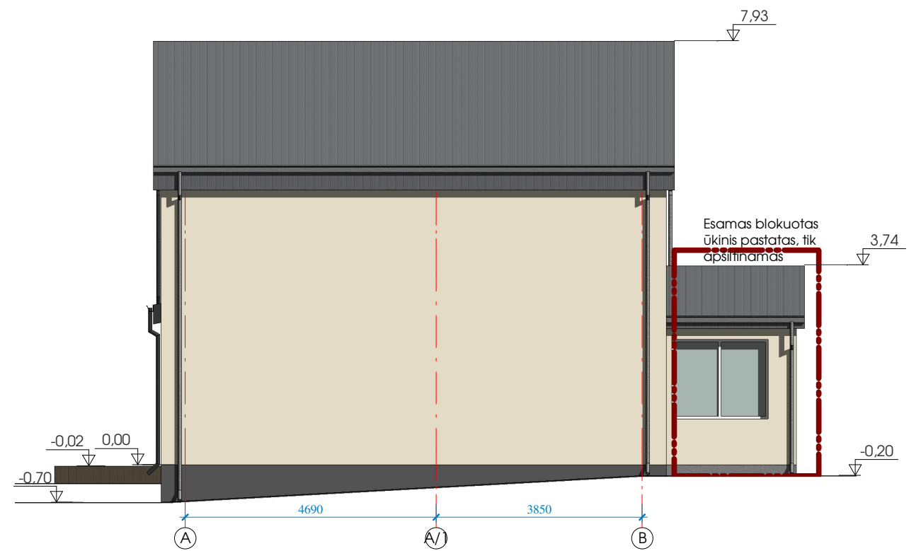
② Fasadas tarp ašiy A-C. Spalvinis sprendimas 1:100
