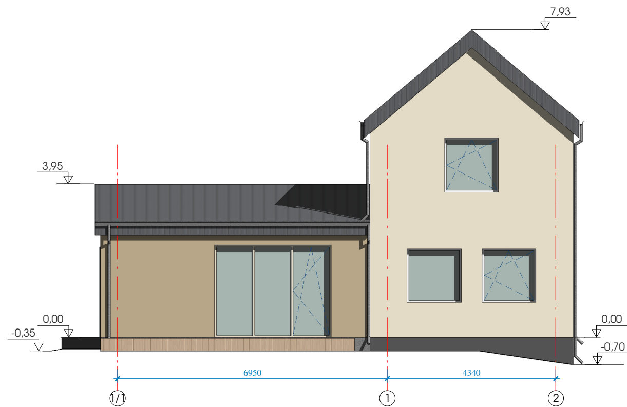
① Fasadas tarp ašiy 1/1-2. Spalvinis sprendimas 1:100
