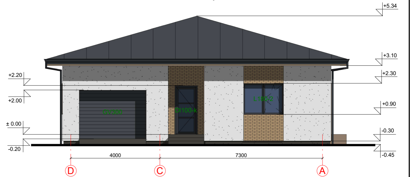
FASADAS TARP AŠIŲ D-A M1:100
