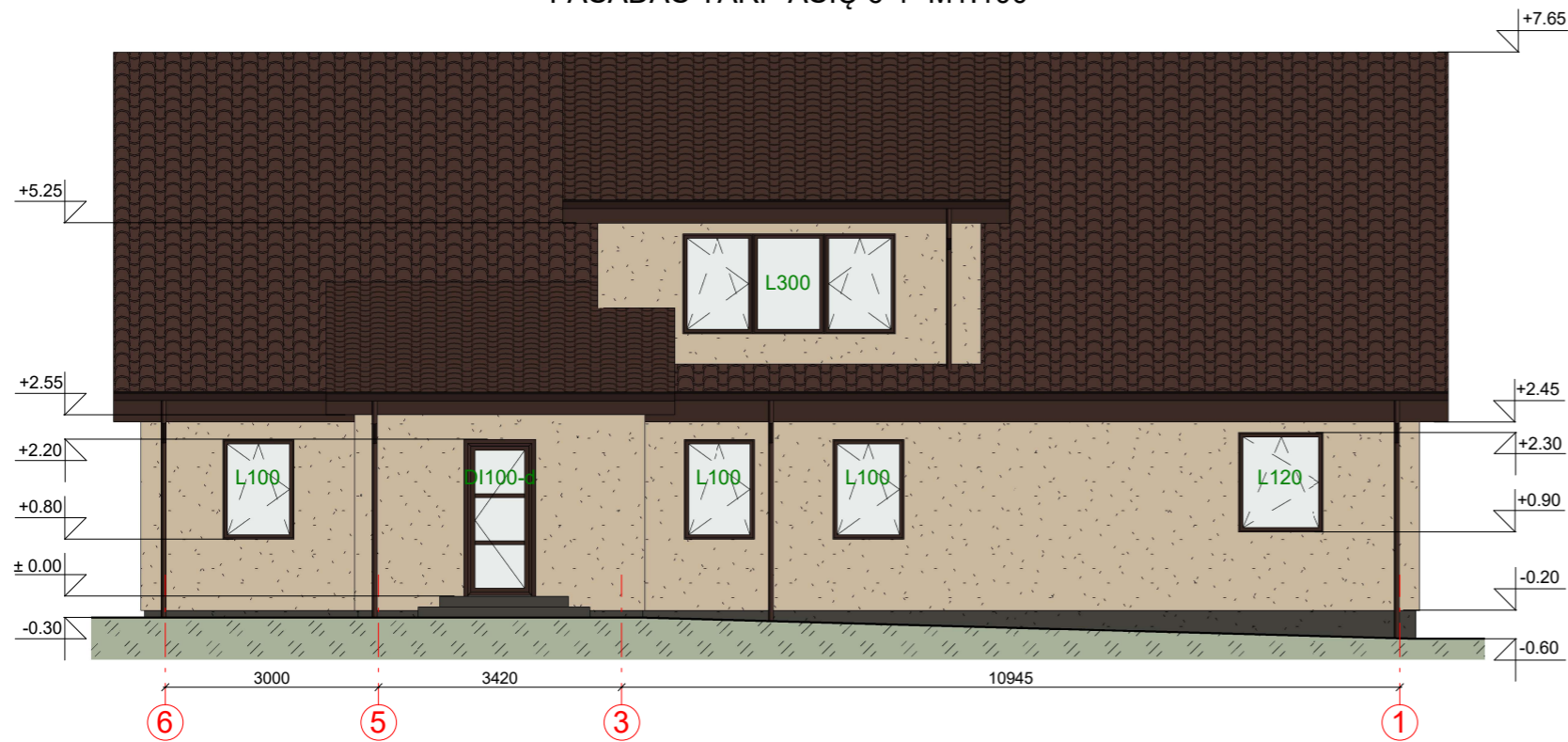
FASADAS TARP AŠIŲ 6-1 M1:100
