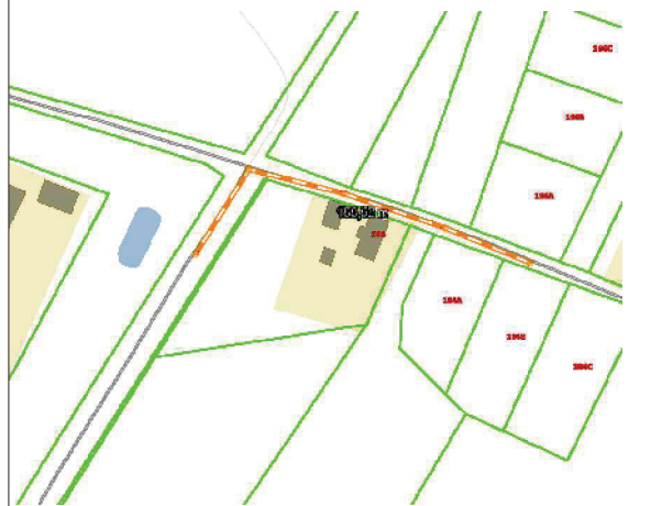
Priešgaisrinio vandens paėmimo schema: Priešgaisrinis vanduo imamas iš prūdo esančio 156m iki projektuojamo namo
