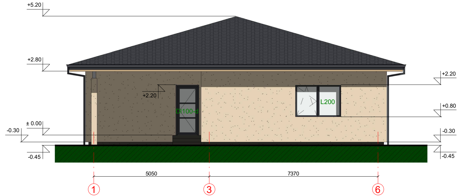
FASADAS TARP AŠIŲ 1-6 M1:100
