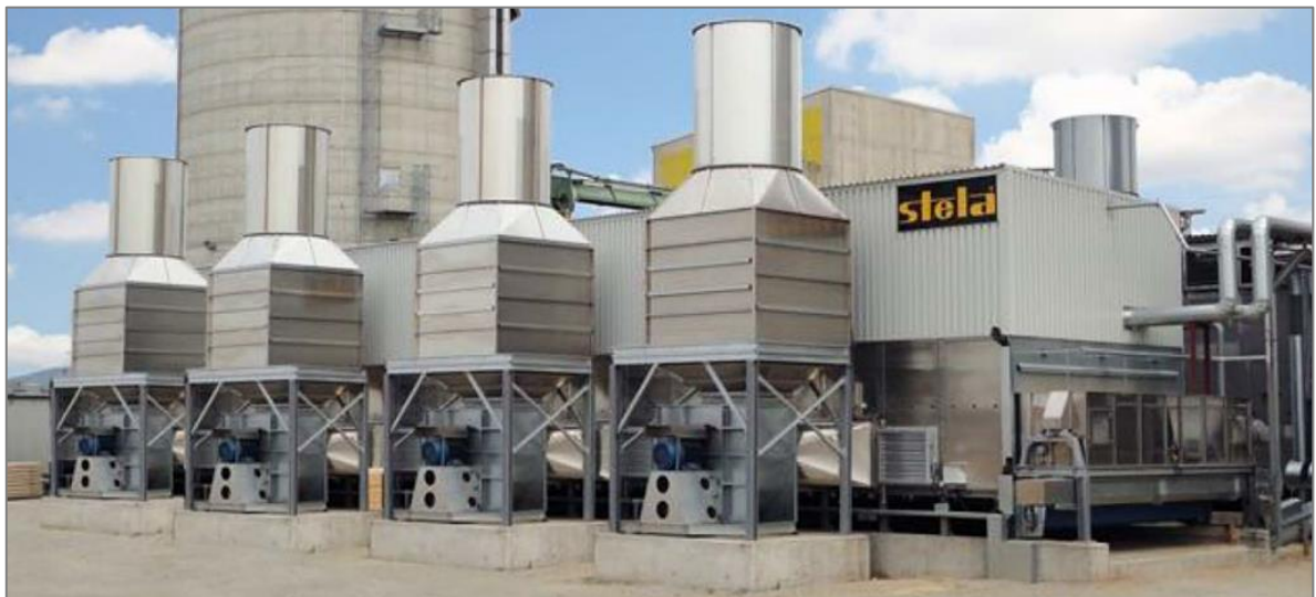
5.6 pav. Preliminari juostinės džiovyklos vizualizacija
