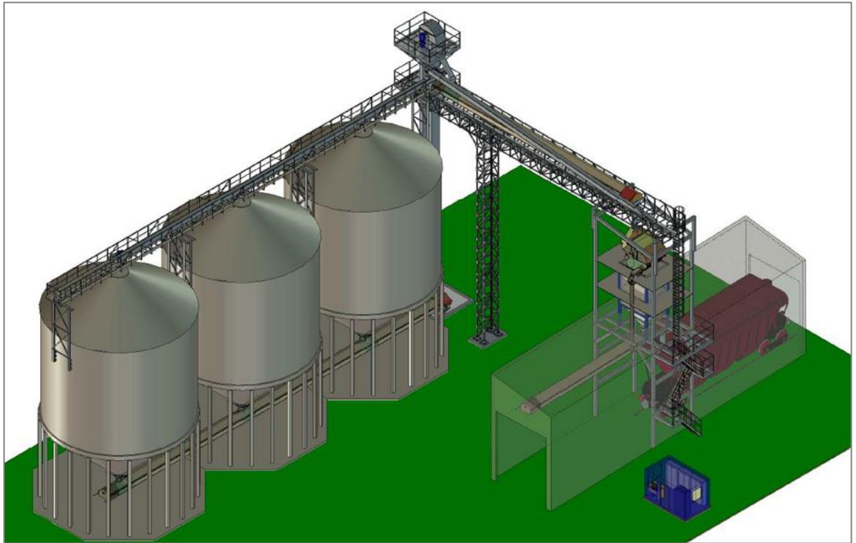
5.13 pav. Preliminari silosų ir pakrovimo mazgo vizualizacija
