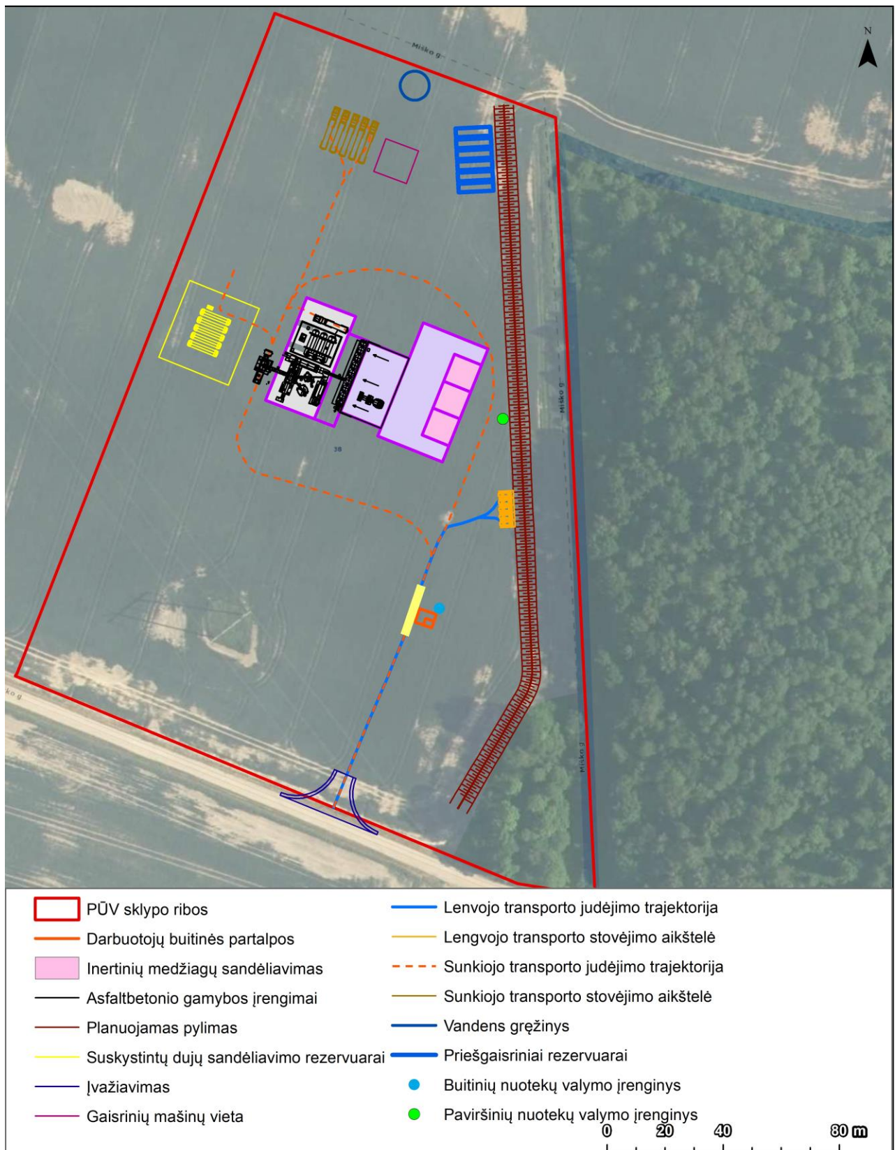
1 pav. Planuojami statiniai, įrenginiai, aikštelės
