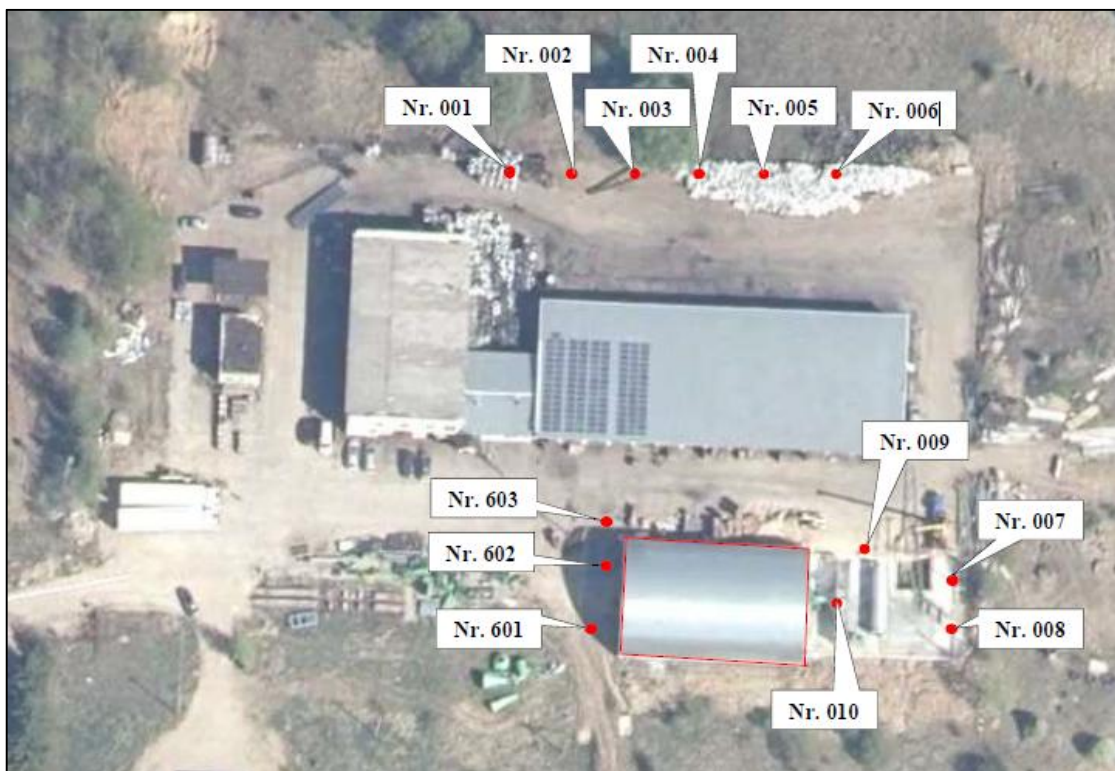
17 pav. Stacionarių oro taršos šaltinių schema
