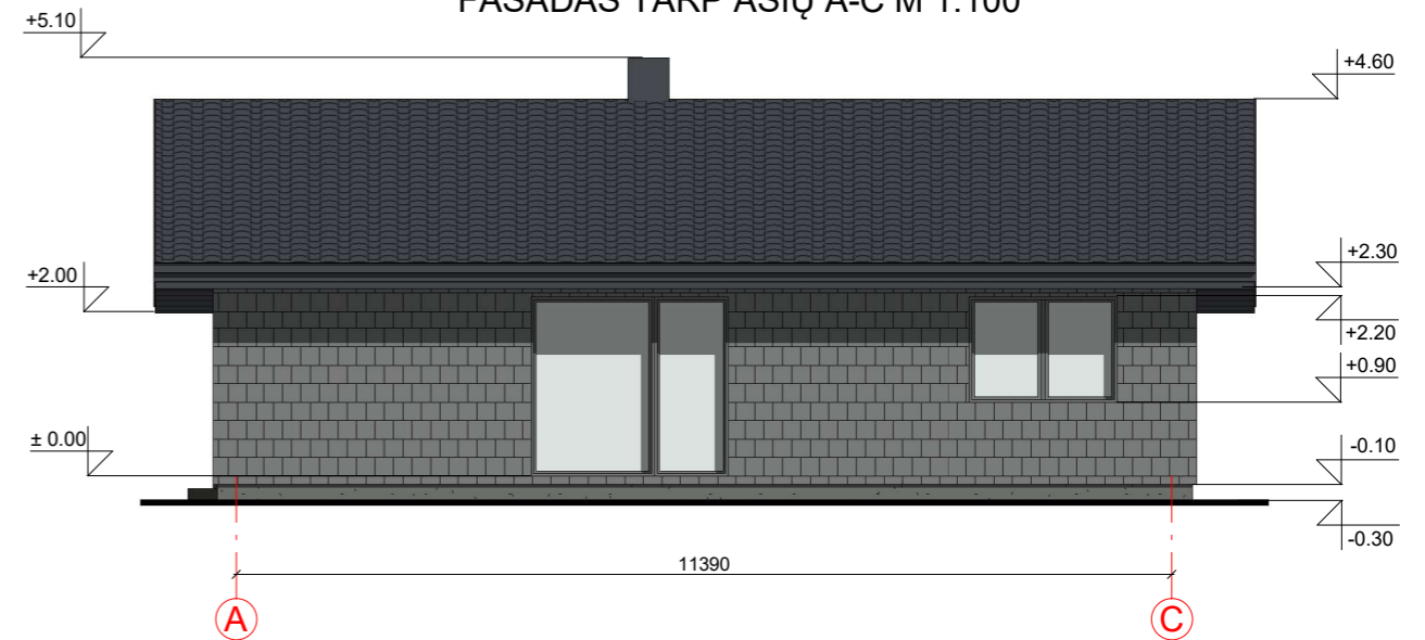
FASADAS TARP AŠIŲ A-C M 1:100
