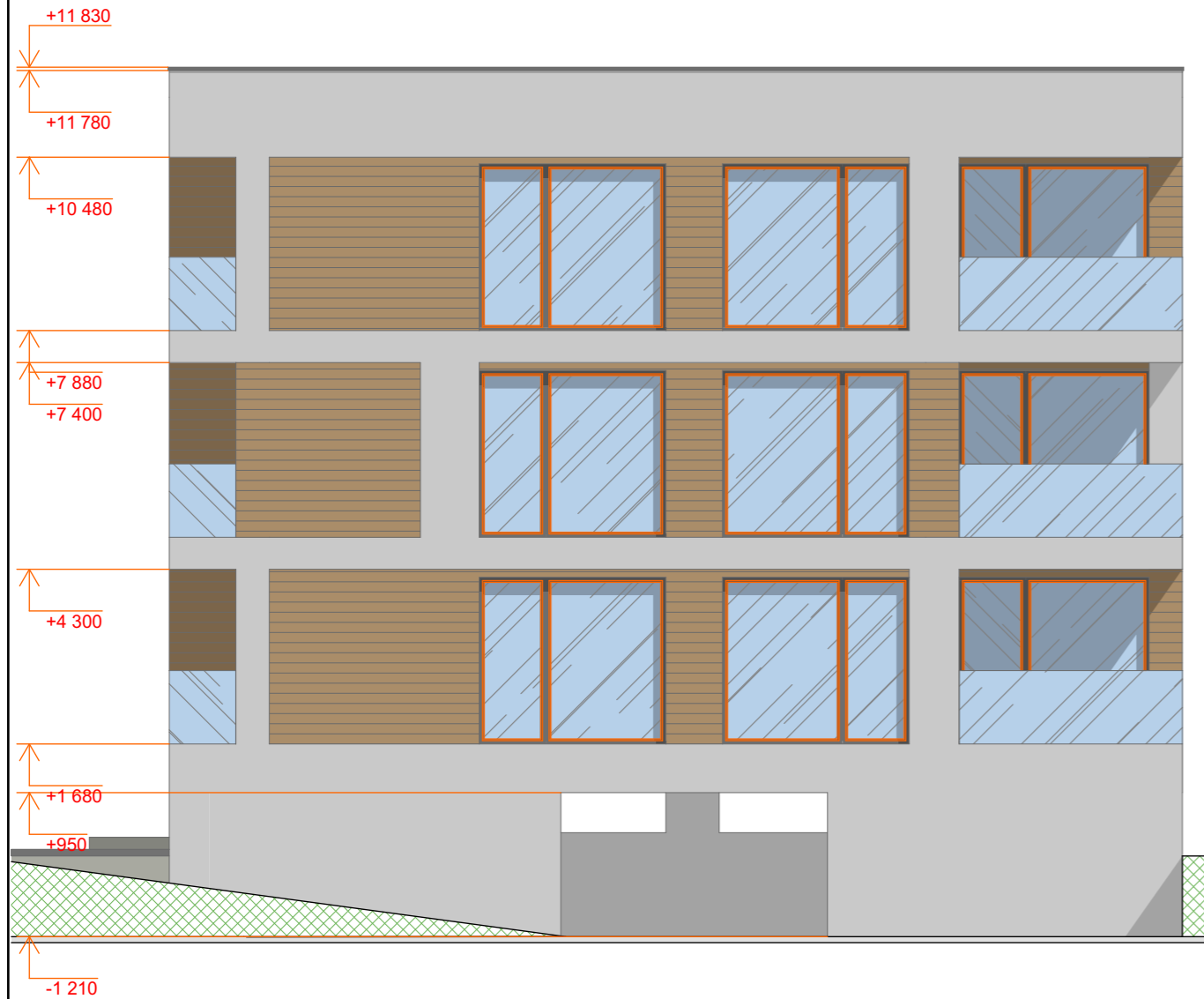
FASADAS TARP AŠIŲ 1-5 M 1:100
