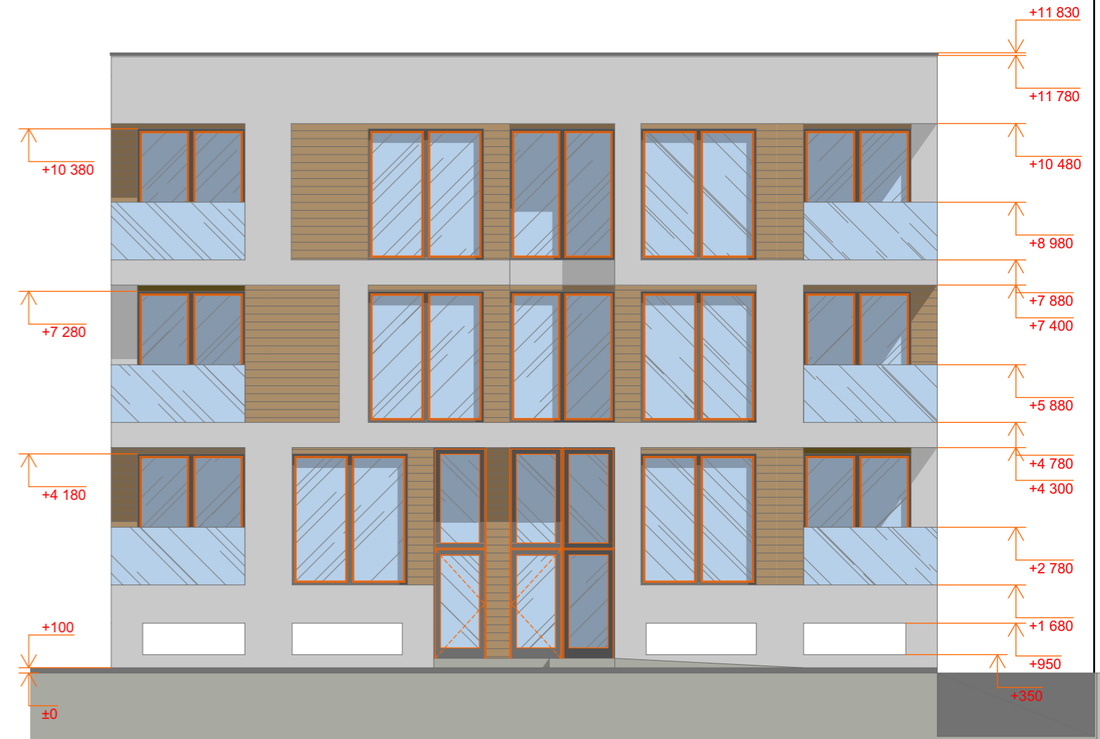
FASADAS TARP AŠIŲ A- I M 1:100
