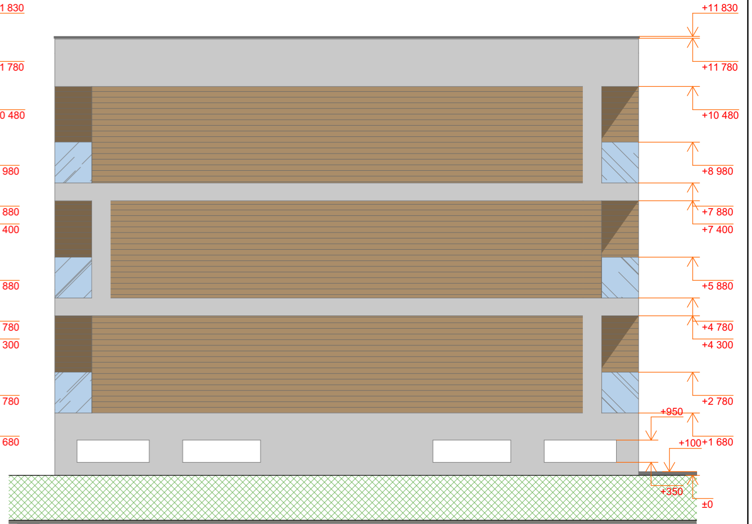
FASADAS TARP AŠIŲ 5-1 M 1:100
