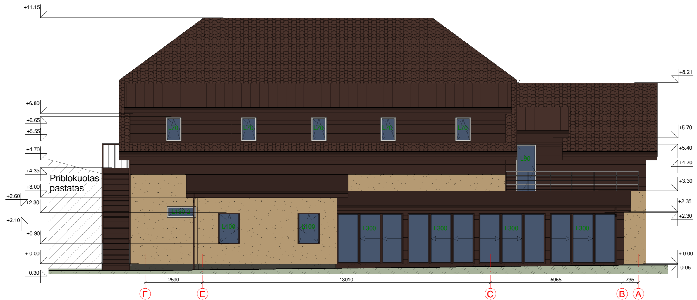
FASADAS TARP AŠIŲ F-A M1:100
