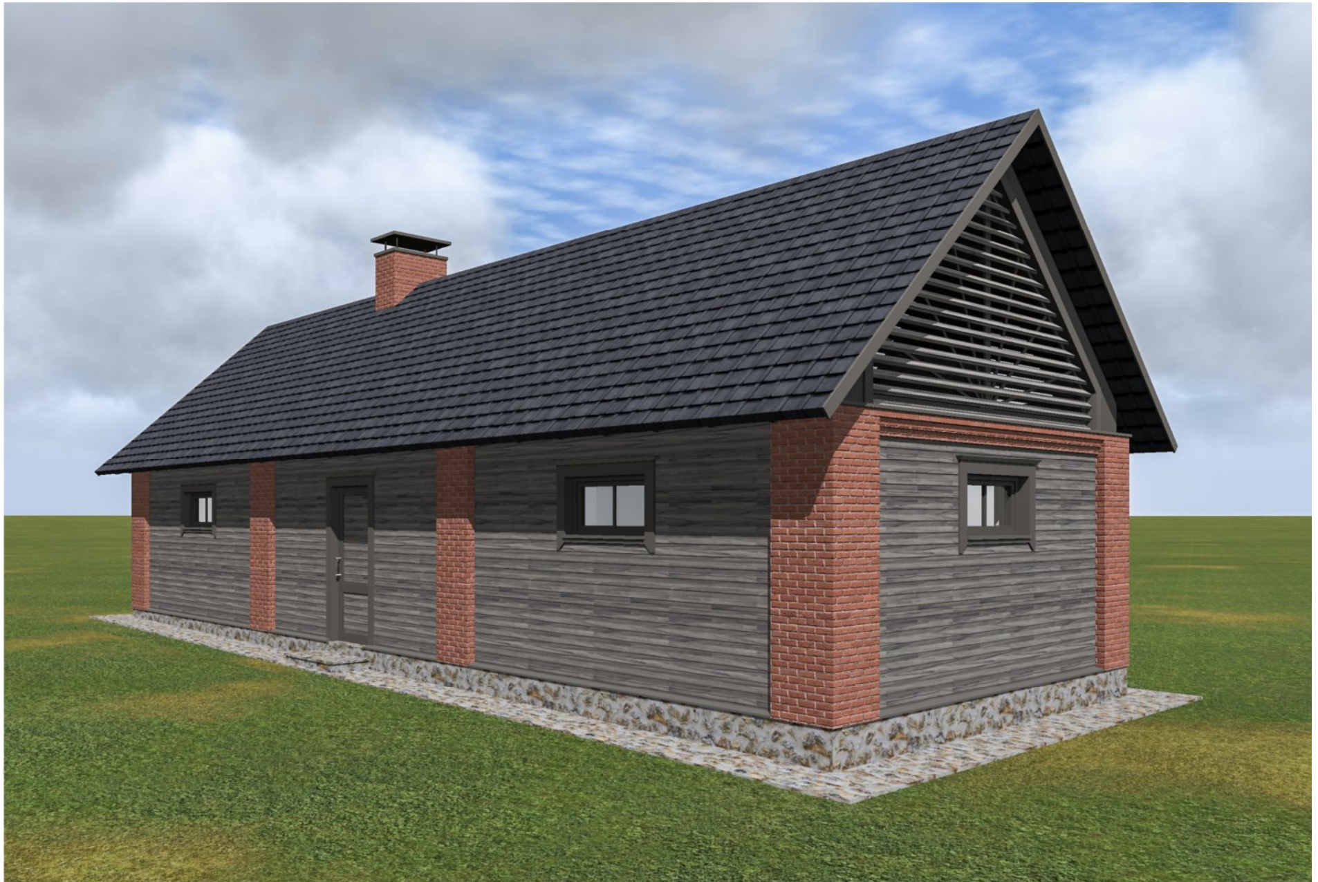
FRONTONO UŽDENGIMAS ŽALIUZE TANKESNIS
