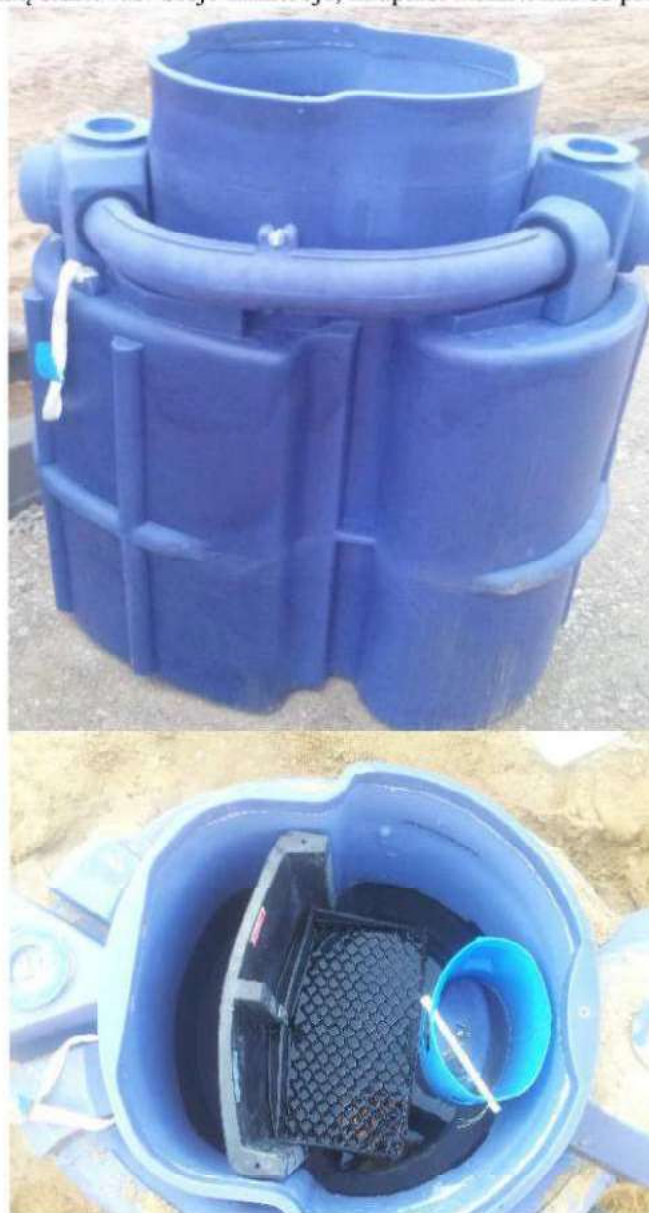
4 pav. Standartinis polietileninis naftos produktų skirtuvas su integruotu smėlio ir purvo nusodintuvu, apibėgimo linija ir automatiniu avariniu uždoriu. (kairėje smėlio ir purvo nusodintuvas, dešinėje naftos produktų skirtuvas su automatiniu avariniu uždoriu).
