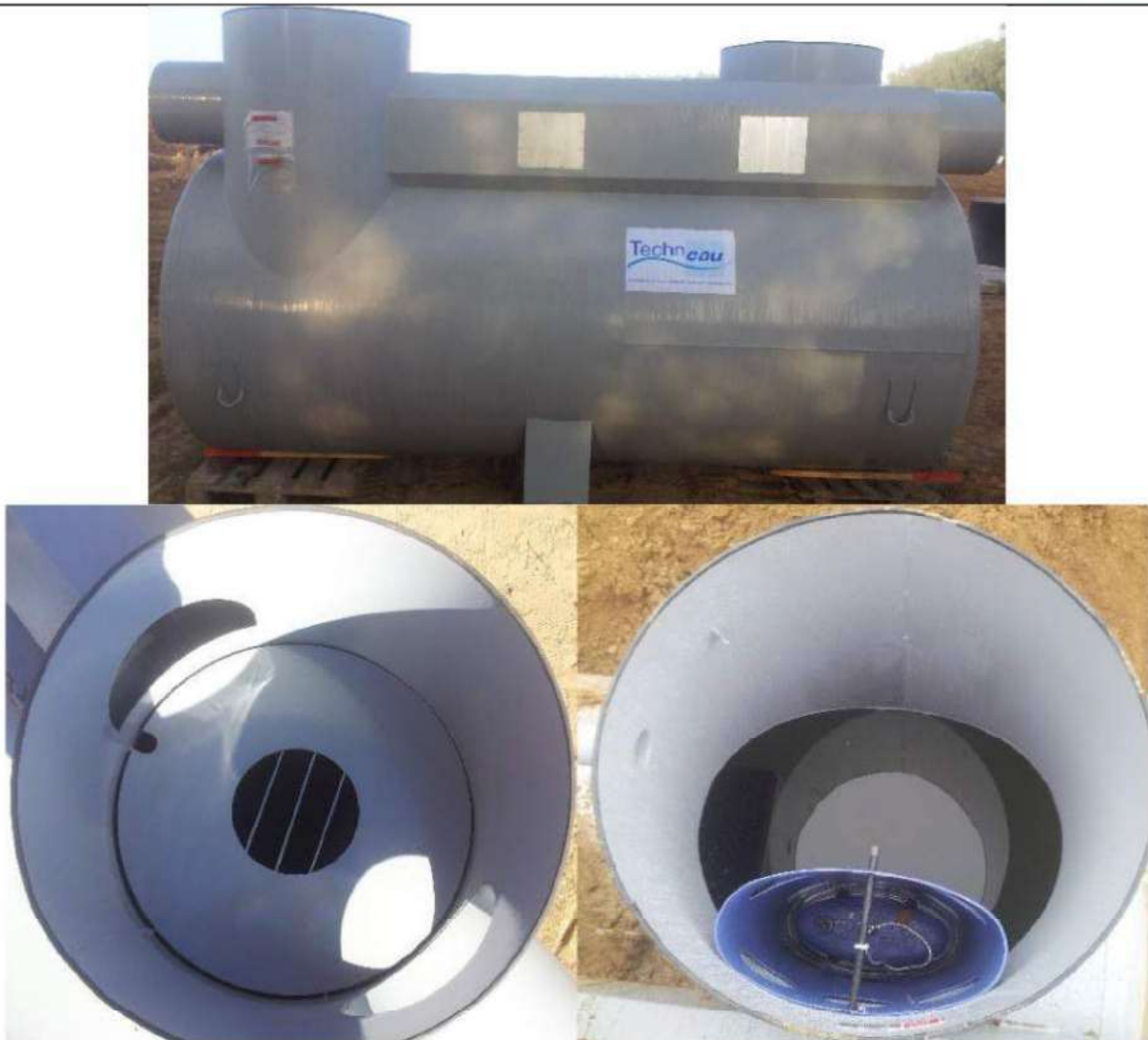
5 pav. Standartinis plieninis naftos produktų skirtuvas su integruotu smėlio ir purvo nusodintuvu, apibėgimo linija ir automatinio avariniu uždoriu. (kairėje smėlio ir purvo nusodintuvas su apsauginėmis grotelėmis; dešinėje naftos produktų skirtuvas su automatinio avariniu uždoriu).
