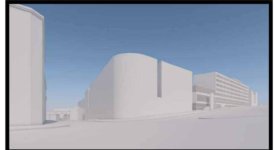
VARIANTAS B4 Variantas pasirinktas vystyti, dėl Vilniaus miesto istorinei daliai būdingo plastiško kampo linkio bei kylančios karnizo linijos formavimo, būdingo kylančio reljefo gatvėms. Didesnis pastato aukštis padeda neutralizuoti „Panoramos“ viešbučio dominavimą Šopeno - Seinų g. išklotinėje.
