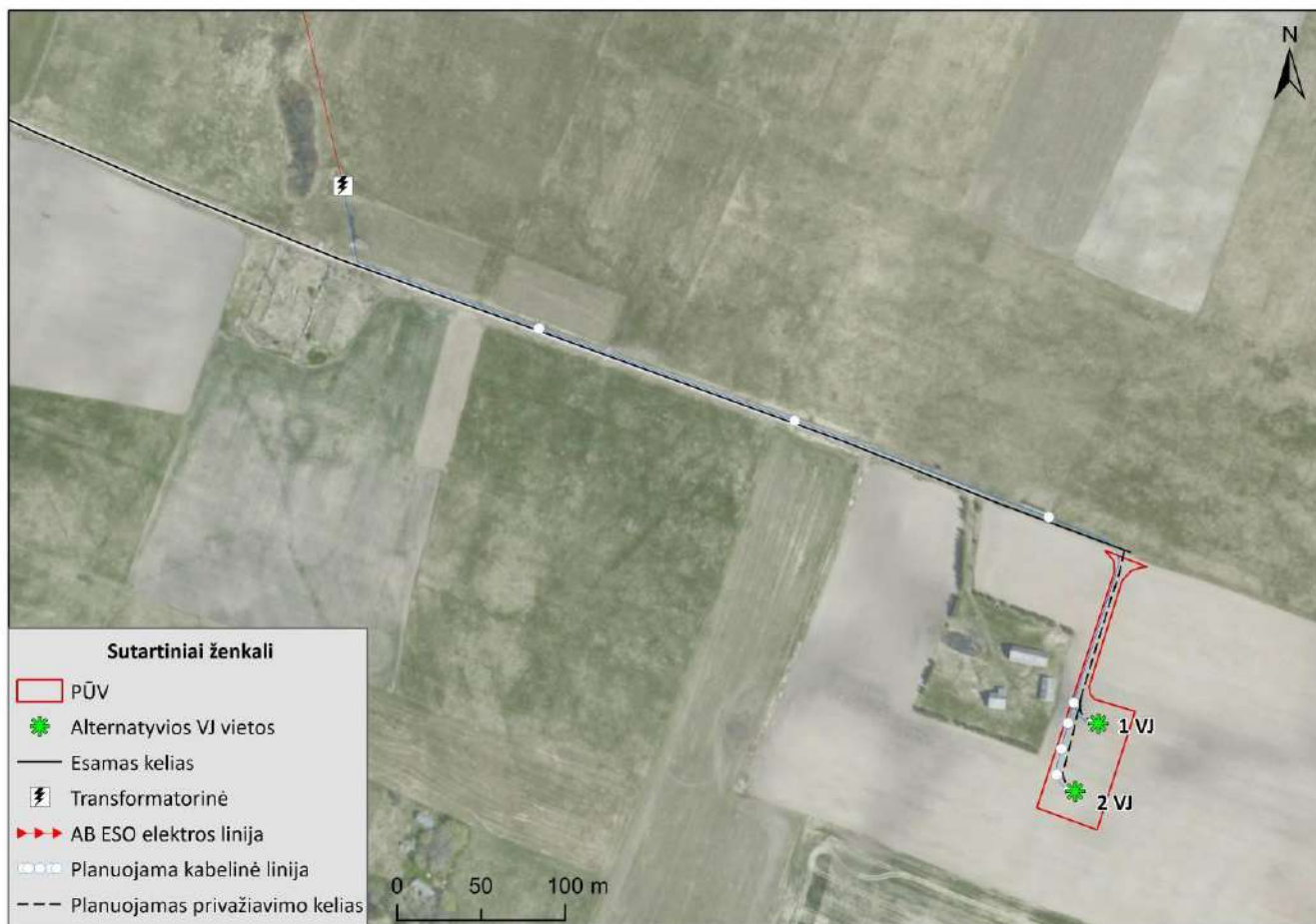
3 pav. PŪV slypas, planuojama vėjo jėgainė vienoje iš alternatyvių vietų ir numatomi bei esami prisijungimai prie inžinerinės infrastruktūros
