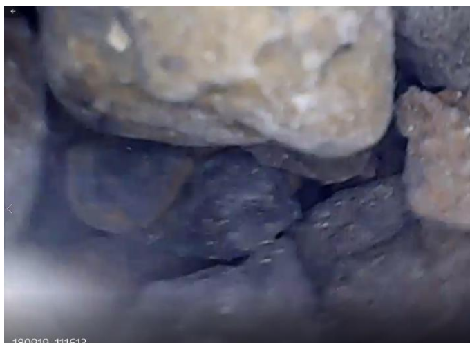
12 pav. Pastato 28P1p denginio tyrimas endoskopu. Denginys apšiltintas keramzitu.
