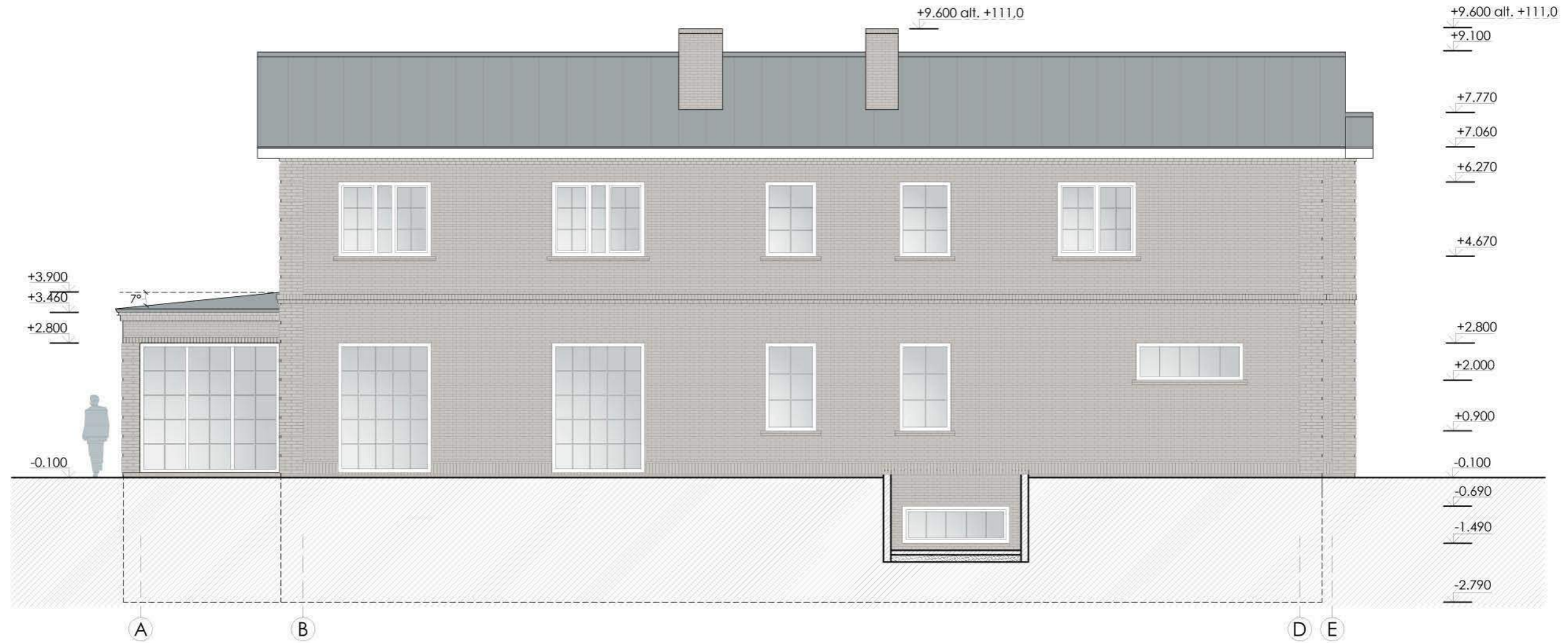
FASADAS TARP AŠIŲ A-E M 1:100
