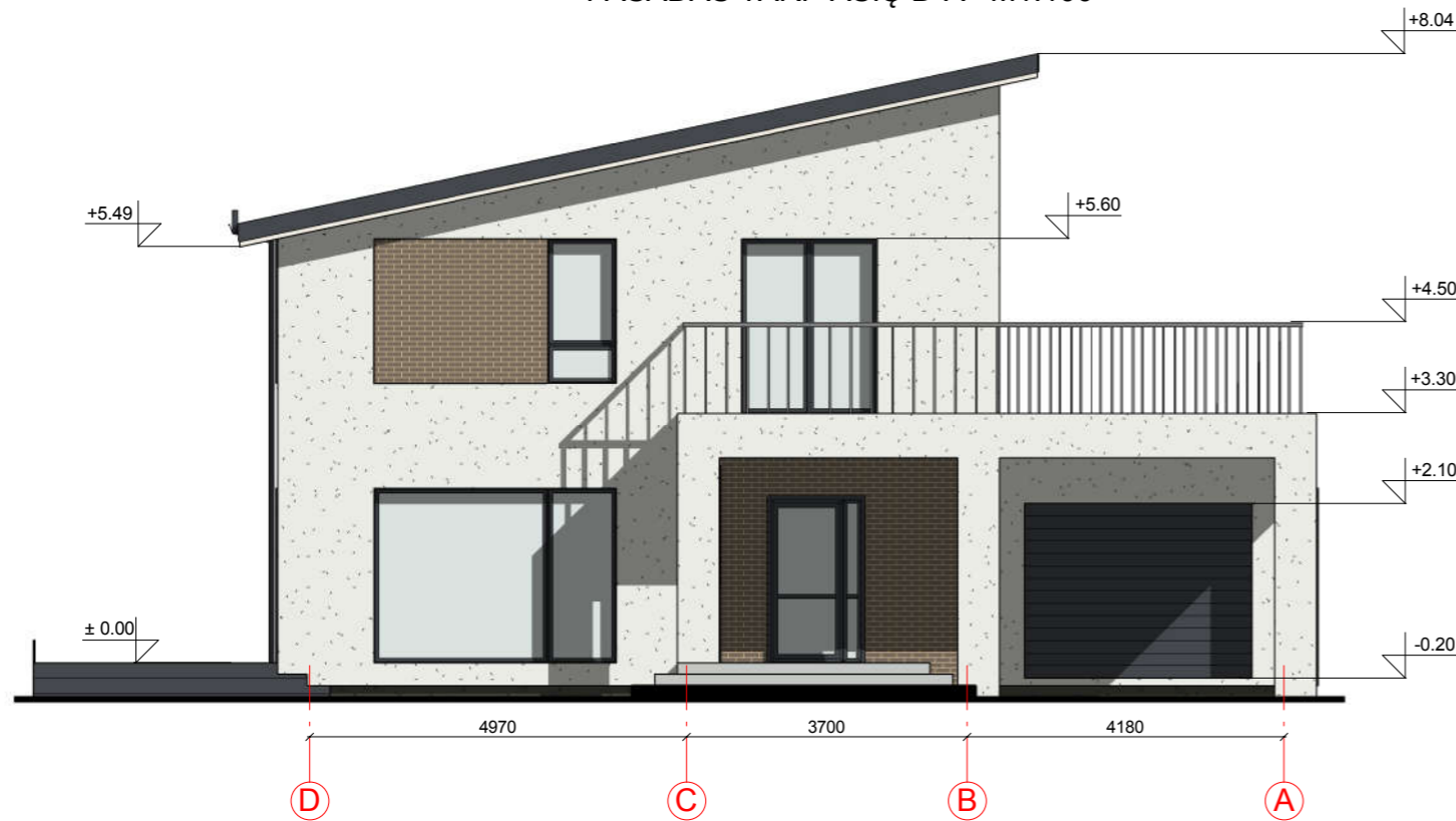
FASADAS TARP AŠIŲ D-A M1:100
