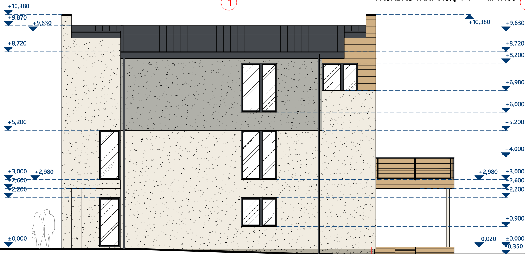
FASADAS TARP AŠIŲ C-A M 1:100
