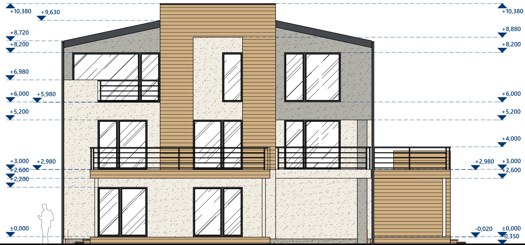
FASADAS TARP AŠIŲ 1-4 M 1:100
