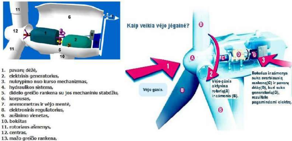
3 pav. Vėjo jėgainės konstrukcija ir veikimo principas
