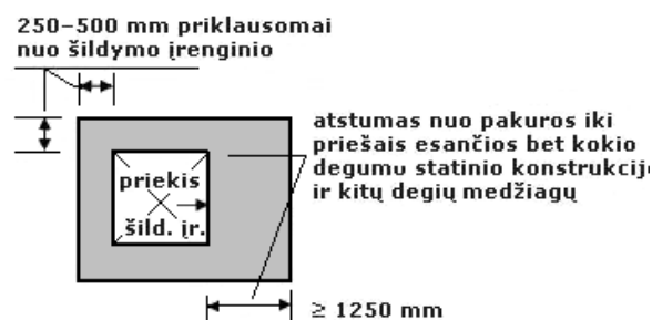
2 pav. Atstumo tarp šildymo įrenginio ir statinio konstrukcijos ir kitų degių medžiagų nustatymo principas
