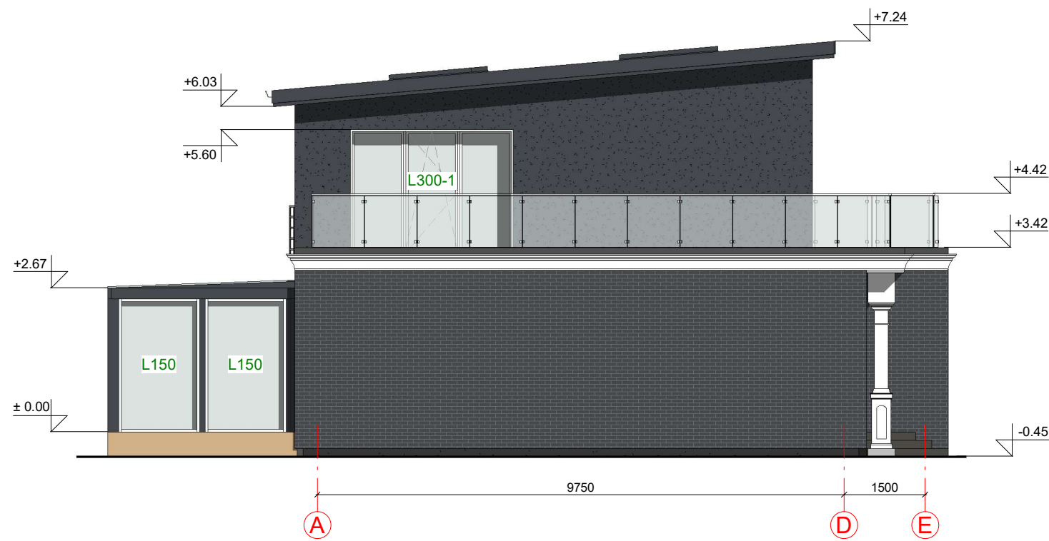
FASADAS TARP AŠIŲ A-E M 1:100
