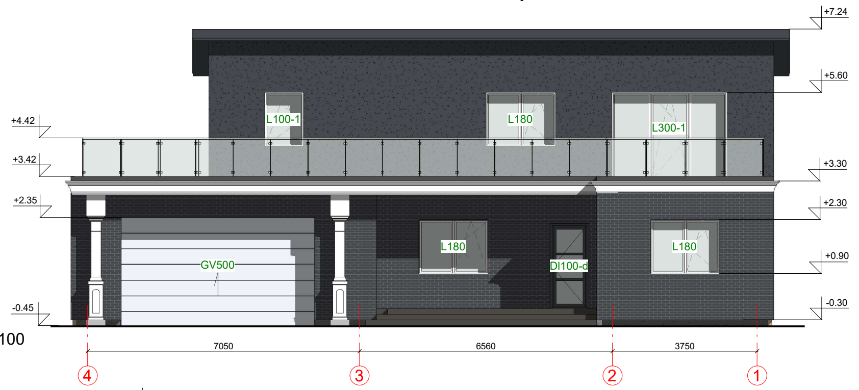
FASADAS TARP AŠIŲ 4-1 M 1:100
