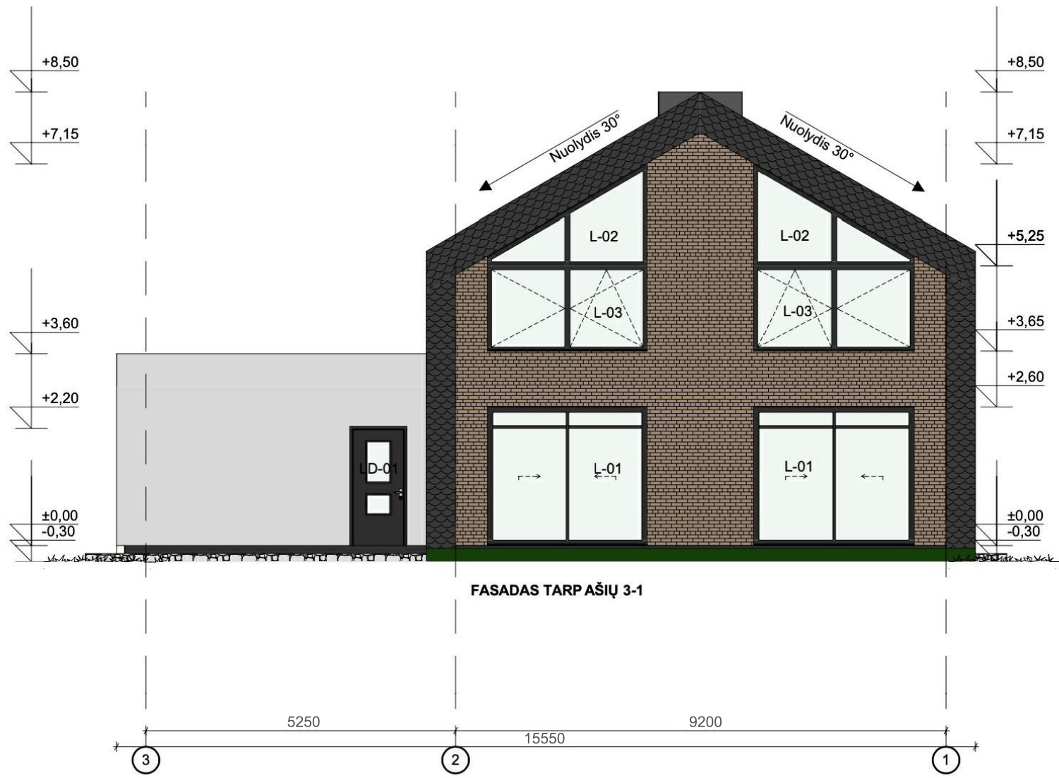
FASADAS TARP AŠIŲ 3-1 M1:100
