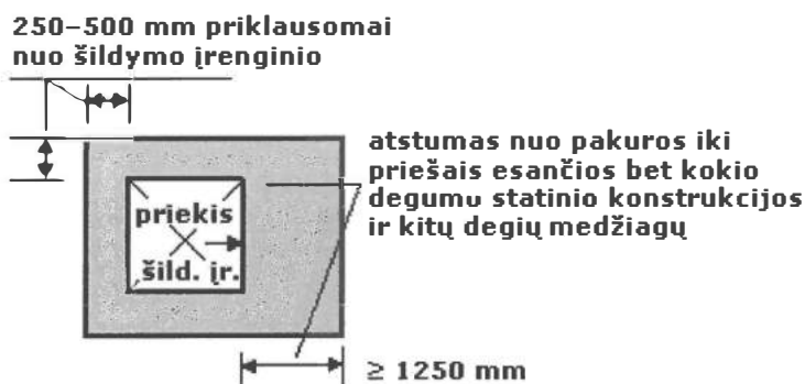
4 paveikslas. Atstumo tarp šildymo įrenginio ir statinio konstrukcijos ir kitų degių medžiagų nustatymo principas
