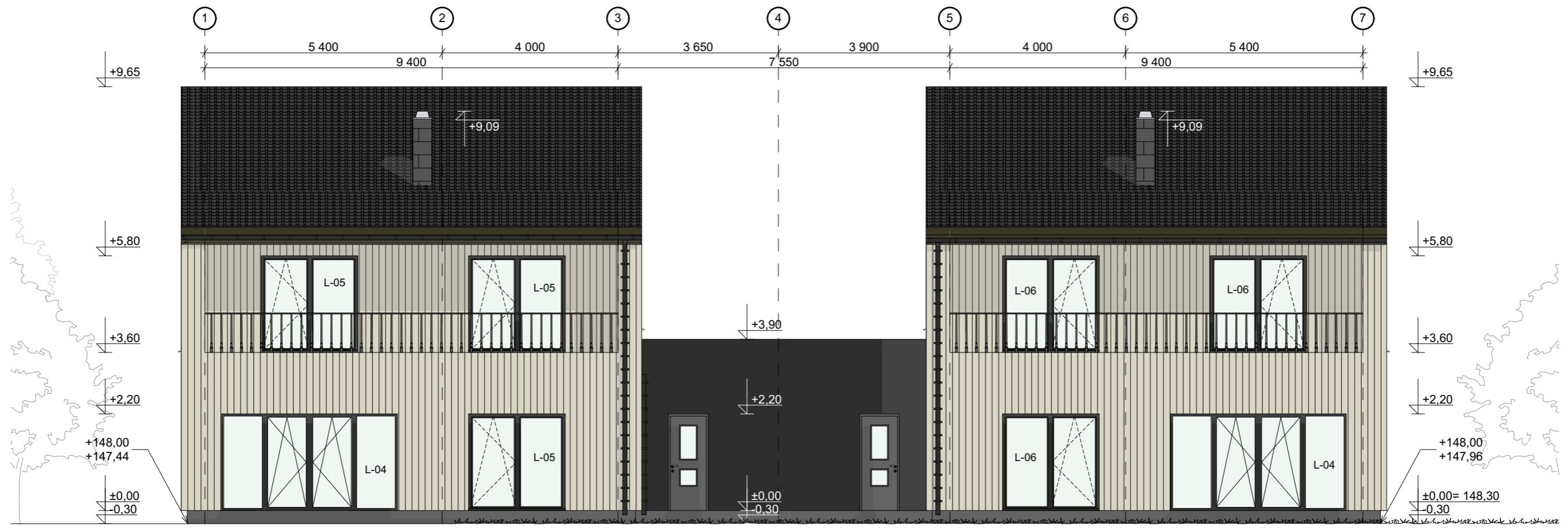
FASADAS TARP AŠIŲ 1-7 Tinko plotas RAL 7016 25.23 m 2 Medinių dailienčių plotas 79.12 m 2
