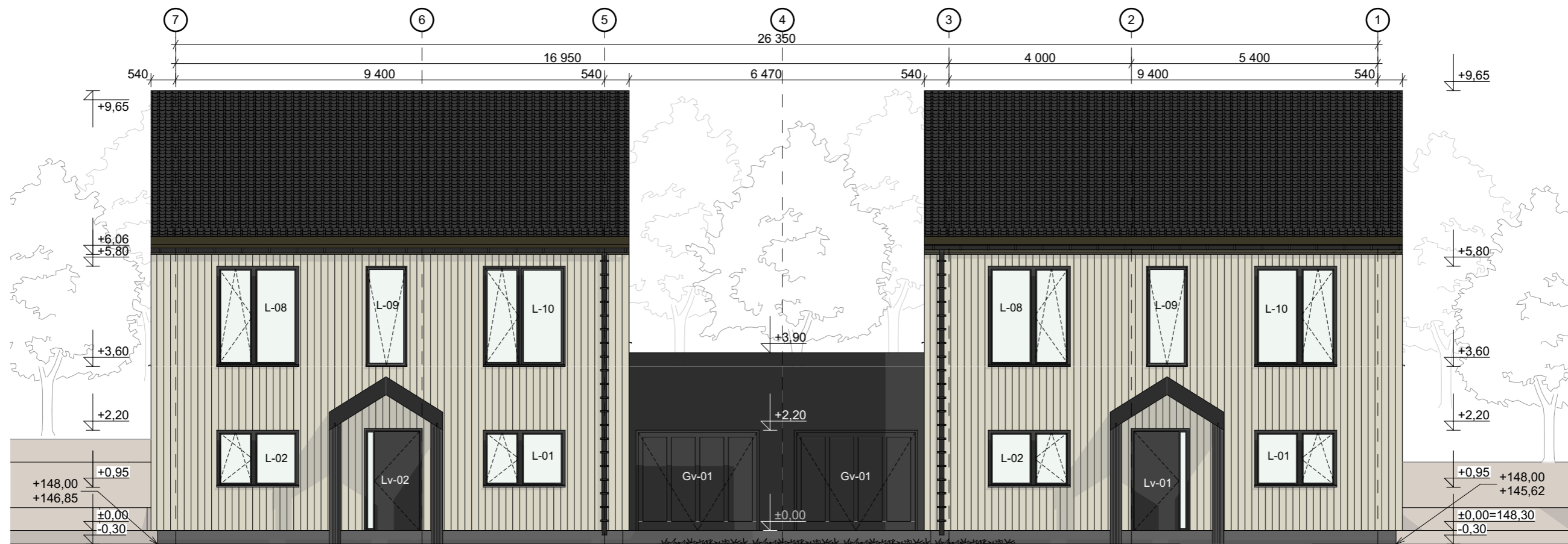
FASADAS TARP AŠIŲ 7-1 Medinių dailylenčių apdailos plotas 91.44 m 2 Tinko apdailos plotas RAL 7016 13.09 m 2
