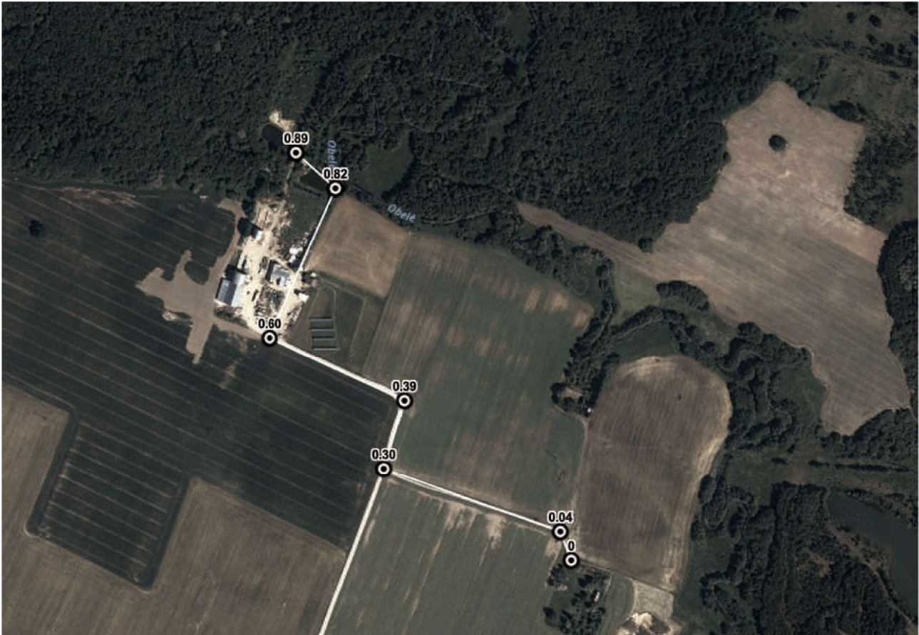
3pav. Atstumas iki vandens tenkinio gaisro gesinimui
