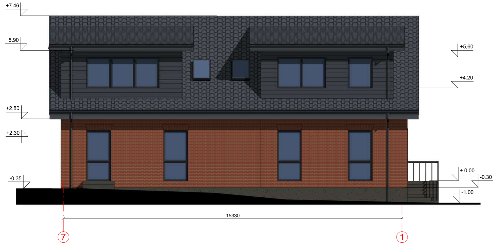
FASADAS TARP AŠIŲ 7-1 M1:100
