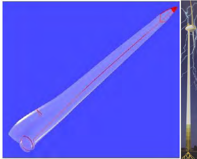
5.9 pav. Mentės ir visos VJ apsauga nuo žaibo iškvos
