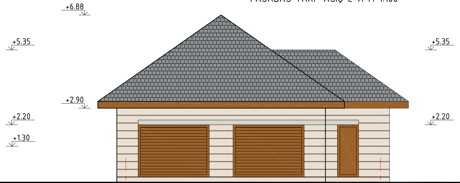
PAGALBINIO ŪKIO PASKIRTIES PASTATO FASADAS TARP AŠIŲ C-A M 1:100
