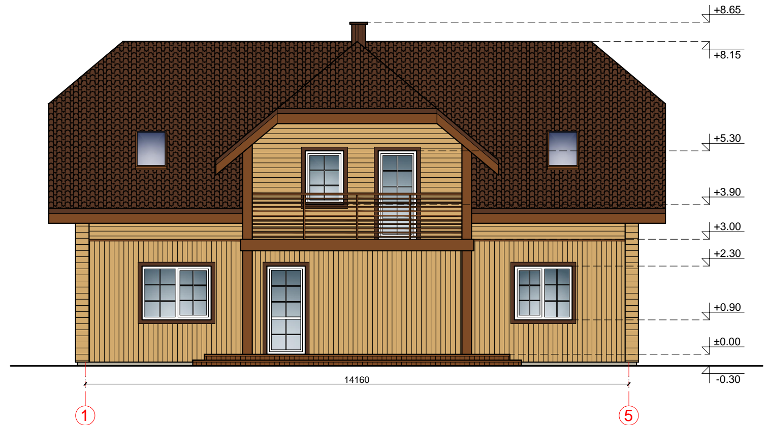
FASADAS TARP AŠIŲ 1-5 M 1:100
