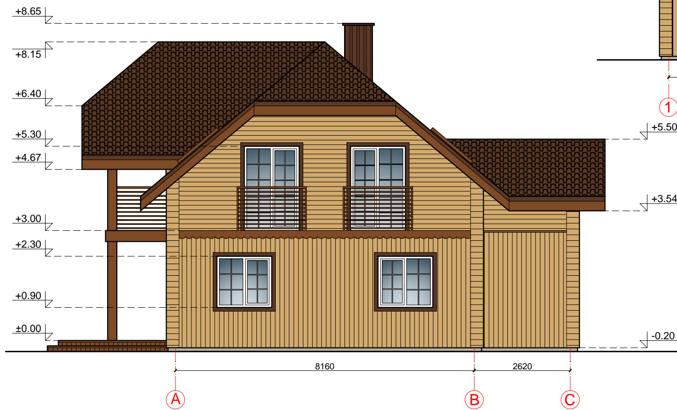
FASADAS TARP AŠIŲ A-C M 1:100
