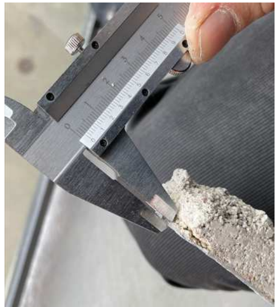
10 pav. Ant smulkiagrūdžio betono išlieta 1,5 mm polimerinė danga su smėlio pabarstu
