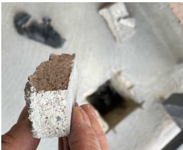
10 pav. Ant smulkiagrūdžio betono išlieta 1,5 mm polimerinė danga su smėlio pabarstu
