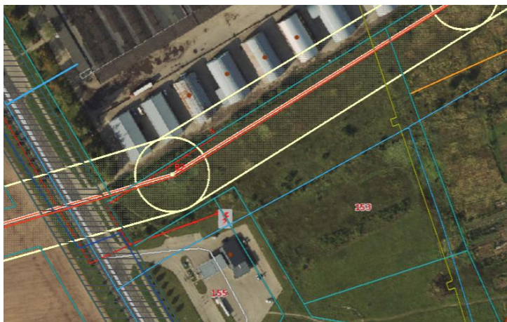
110 kV elektros tinklų orinė linija su apsaugos zona.
